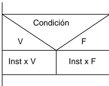
Para representar una decisión se utiliza este símbolo en donde por el lado izquierdo podemos colocar las acciones o Instrucciones que correspondería ejecutar en el caso de que la condición fuera Verdadera y por el lado derecho colocaríamos las acciones o instrucciones a ejecutar cuando la condición fuera Falsa.
