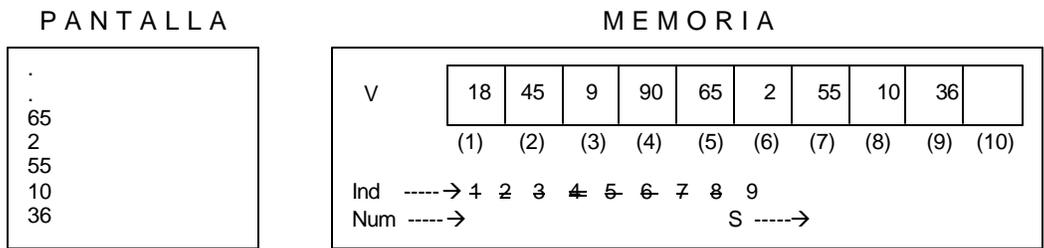
Por último incrementamos el contenido de la variable *Ind* y llegamos al tope ( 10 ). Leemos el último dato que va a ser almacenado en el vector *V* en la posición 10.
