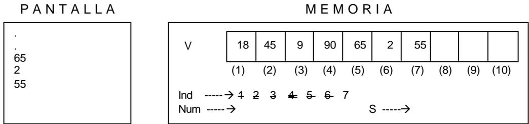
Volvemos a incrementar el contenido de la variable *Ind* y volvemos a leer un nuevo dato que quedará almacenado en el vector *V* en la posición 8.
