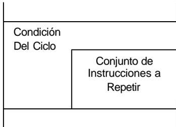
Para representar un ciclo sencillamente en la esquina superior izquierda del bloque correspondiente colocamos la condición y dentro del bloque colocamos las instrucciones o acciones que se debe repetir y que a su vez, por supuesto, dependen de la condición.
